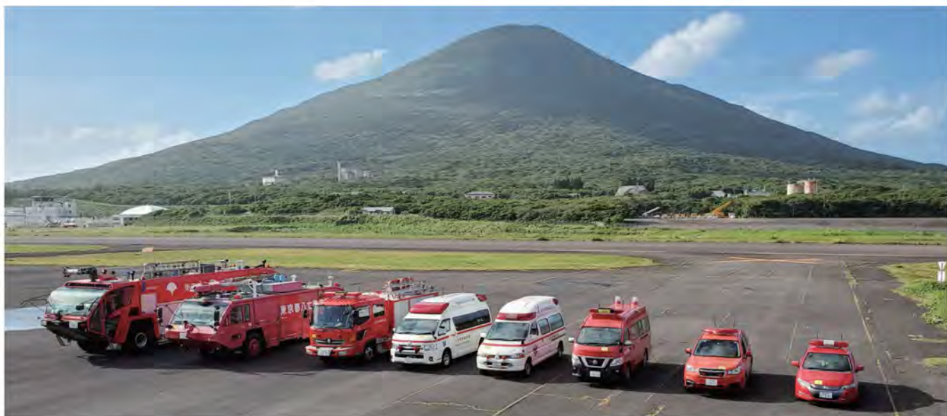
2022 年 3 月に配備された最新の化学消防車。水 10,500 ℓ、薬液 880 ℓ、粉末消火剤 300 キロを積載できる。放水量は毎分 5,200 ℓ
