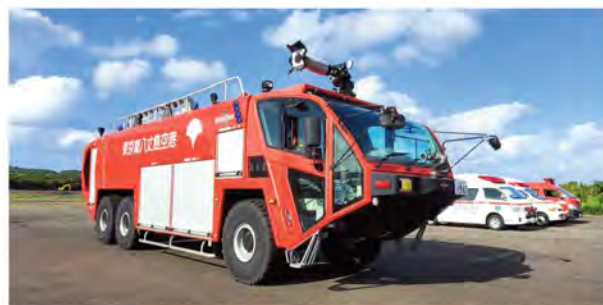
2022 年 3 月に配備された最新の化学消防車。水 10,500 ℓ、薬液 880 ℓ、粉末消火剤 300 キロを積載できる。放水量は毎分 5,200 ℓ
